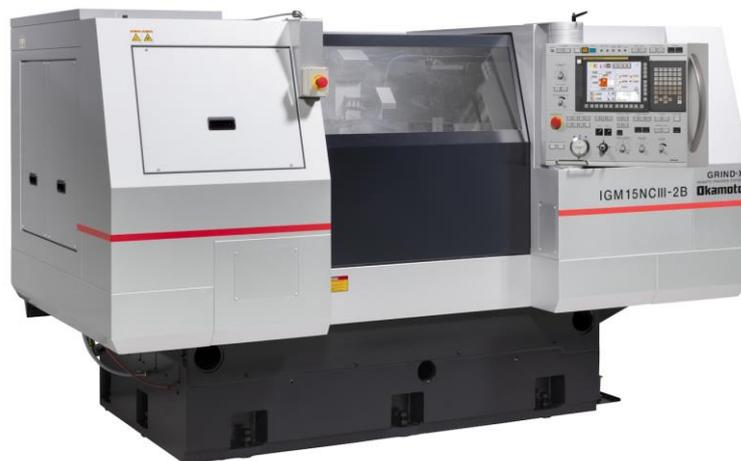
Auf der EMO 2023 in Hannover präsentiert Okamoto, in Halle 11 Stand E65, die neue IGM15NCIII-2B Doppelspindel-Innenrundscheifmaschine. Die neue Maschine vom Typ "Boxer" verfügt über zwei unabhängig voneinander bewegliche Schleifspindeln für Schleifscheiben unterschiedlicher Größe, so dass mehrere Arbeitsgänge in der gleichen Aufspannung durchgeführt werden können.
